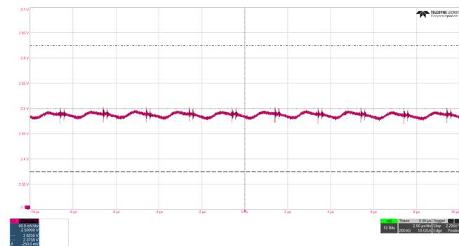
**Figure 20. VDDAUX[2,4,5]/VPP/2V5BUS Output Voltage
