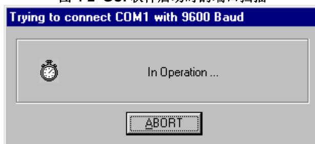
您可以按 **ABORT** 中断此操作，从 **Programmer** → **Setup host connection...(设置主机连接)** 菜单中选择正确的通讯参数。
