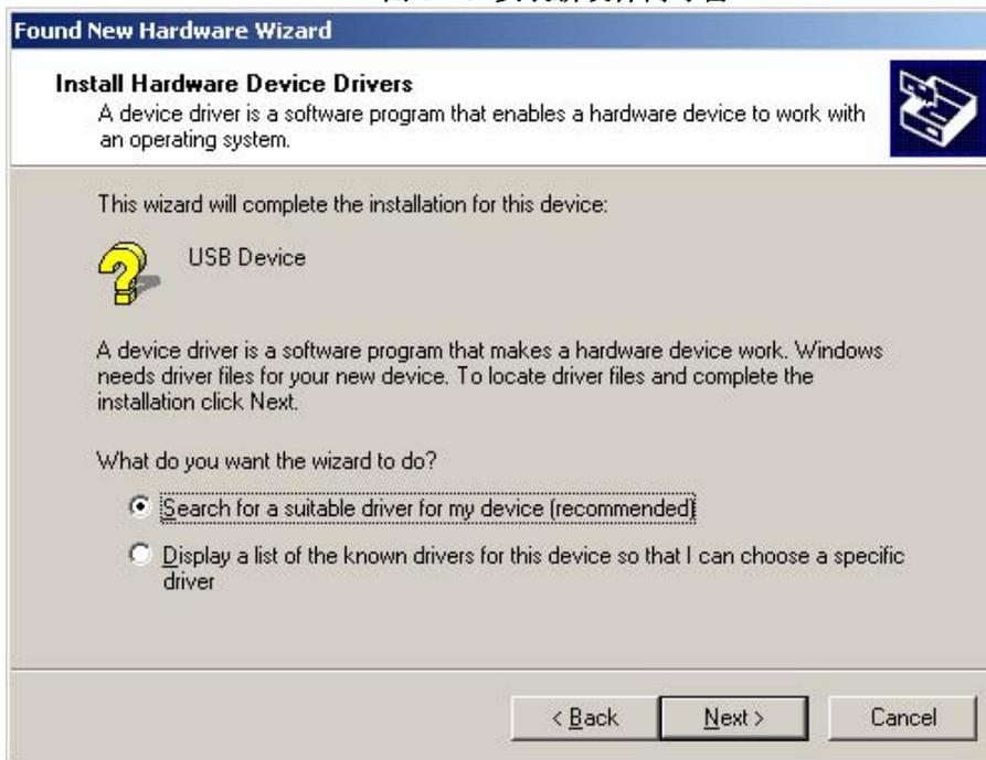
在“What do you want the wizard to do? (希望向导做什么)”提问下，选“Search for a suitable driver for my device (为我的设备选择一个合适的驱动) [recommended 推荐]”，然后点击 **Next >**。显示查找驱动文件“Locate Driver Files(定位驱动文件窗口)”界面。
