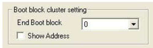
最后的几个区作为引导区。当安全标记设置菜单下的 [Disable Boot block cluster reprogramming(禁止引导区重写)]有效时，执行加密命令后，指定的引导区有效。
