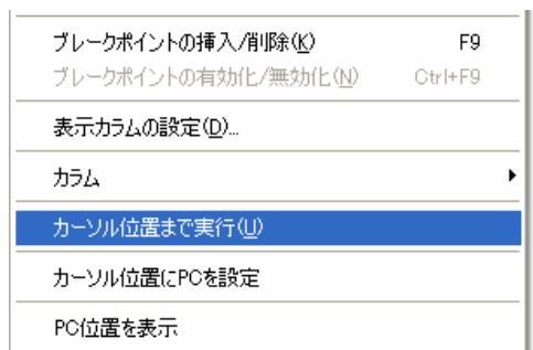
コードは選択した行まで実行され、停止します。このとき、自動的にブレークポイントが挿入され、ブレークが発生した後にブレークポイントが削除されます。
