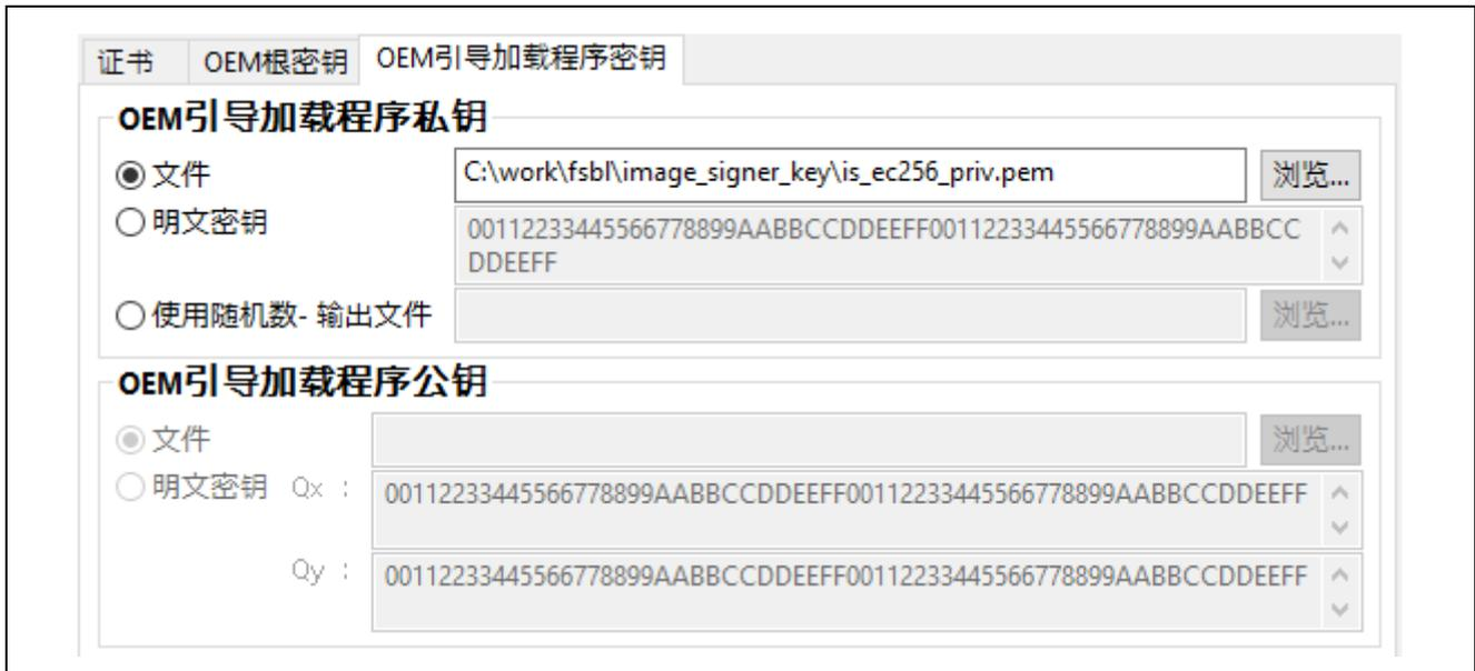
图 6-35 [FSBL] – [OEM引导加载程序密钥]选项卡设置示例
