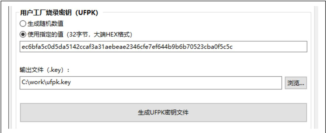
图 6-10 [生成 UFPK] 选项卡，使用指定的值生成 UFPK 的示例
