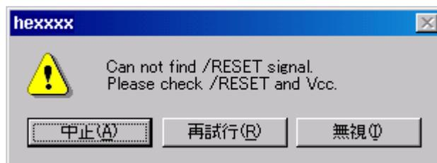
図 3.24 [Can not find /RESET signal]ダイアログボックス
