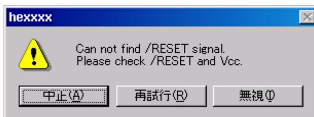
図 3.26 [Can not find /RESET signal]ダイアログボックス
