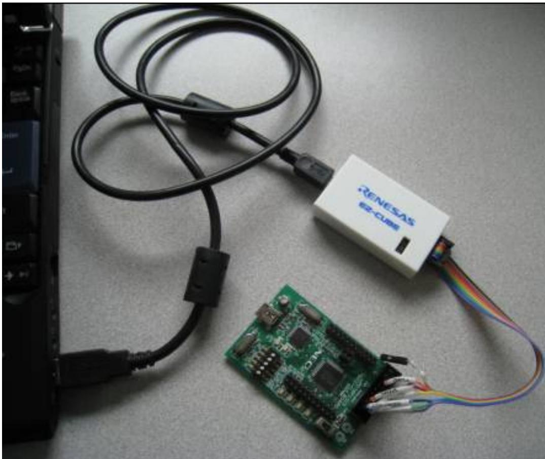
EZ-CUBE工作在调试模式时，与PC机及目标板的连接实例
