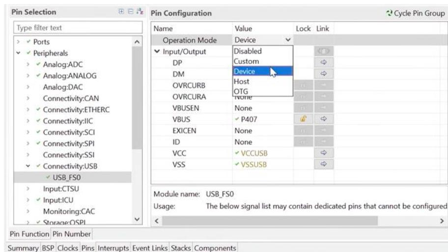
图 5-8: USB 端口将使用器件模式，请进行相应更改
