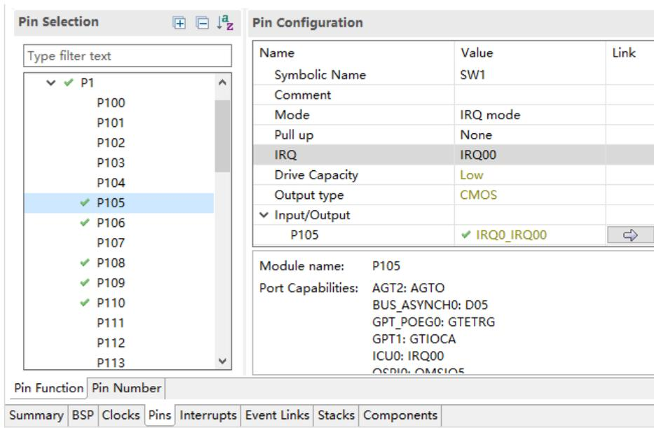
图 4-6: 应已为 IRQ00 正确配置了端口 P105
