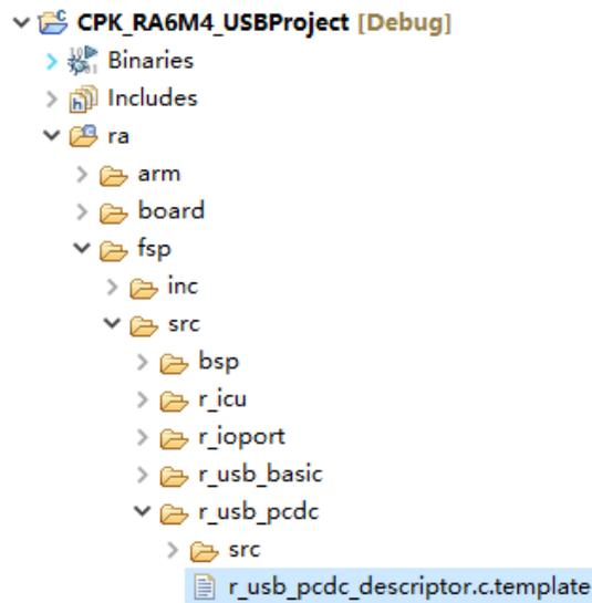
图 5-5: FSP 配置器自动创建 USB 描述符的模板
