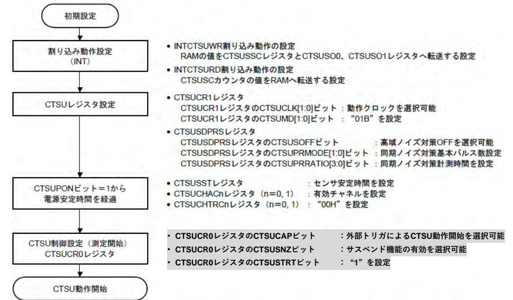
図 15-37 自己容量マルチスキャンモードのソフトウェアフローと動作例
