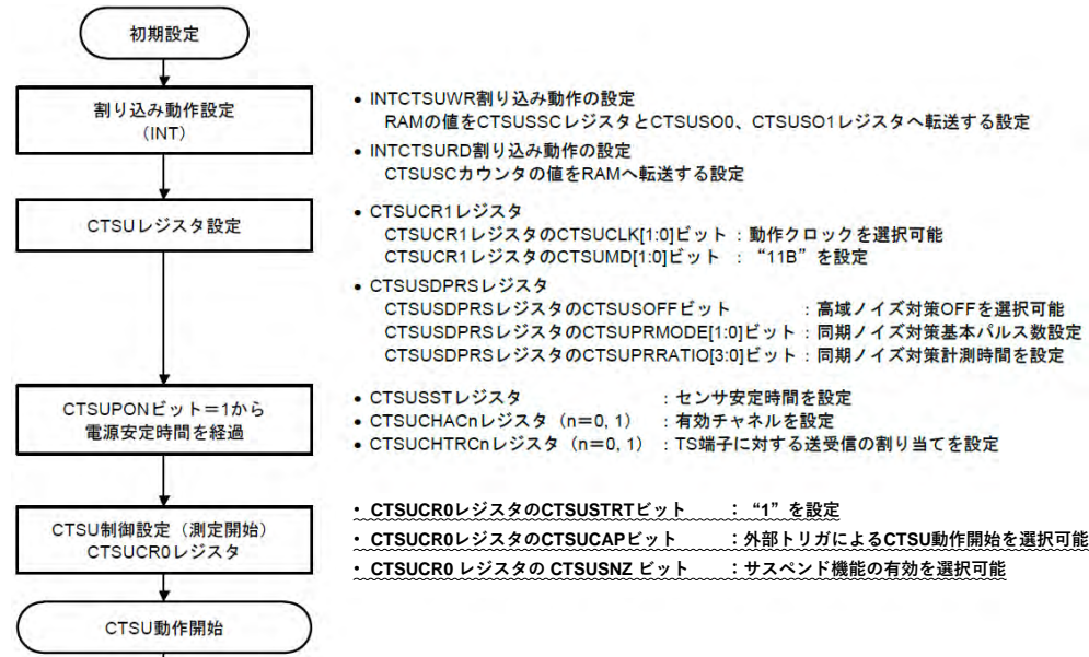
図 15-39 相互容量フルスキャンモードのソフトウェアフローと動作例
