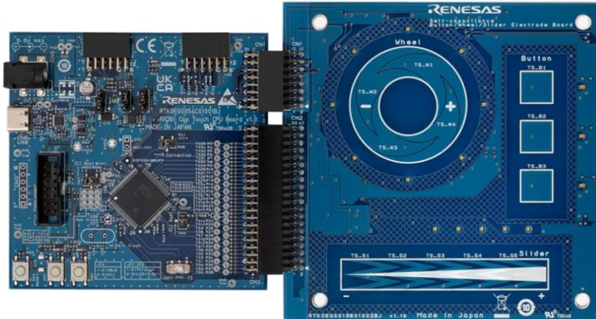
图 5：RX261 电容式触摸评测系统
