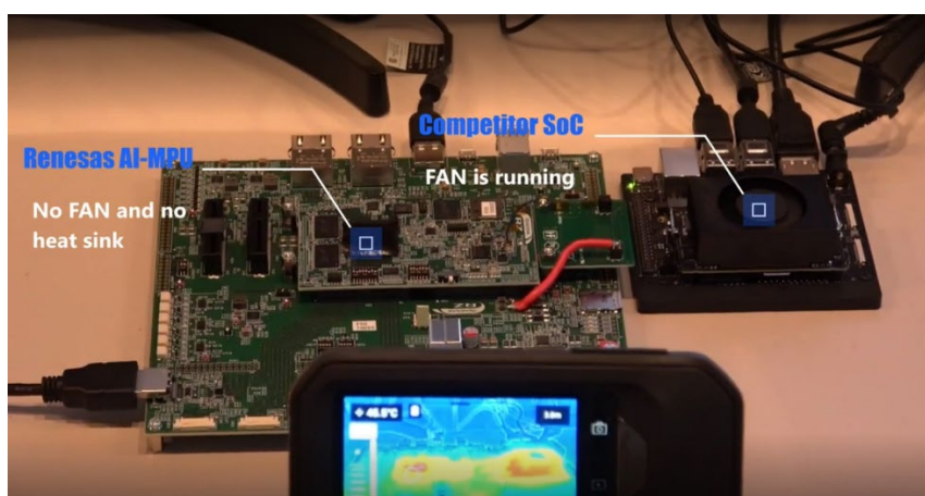
図 12 ファン不要な DRP-AI テストボードと GPU(ファン付き)との発熱比較評価
