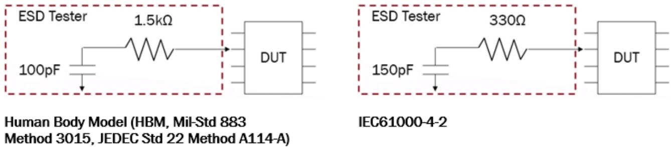
图 4：人体模型和 IEC61000-4-2 放电网络
